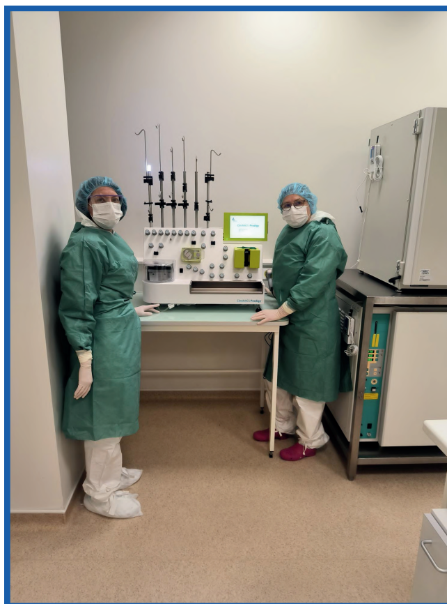
Automate d'immunosélection au sein de l'unité de thérapie cellulaire du CHU de Clermont-Ferrand.
